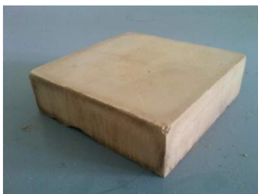
Рис. 2. Образец, полученный из рукавной пыли на водном связующем с термообработкой при температуре 1000°C
