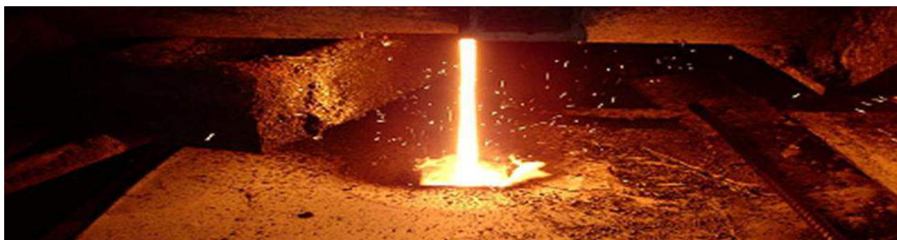
Рис. 3. Вид открытой струи при наполнении кристаллизатора сортовой МНЛЗ
