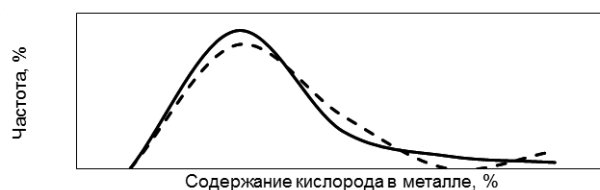
Рис. 2. Содержание кислорода на плавках, разлитых первыми в серии и через новый промежуточный ковш (---), и остальных плавков серии (—)
