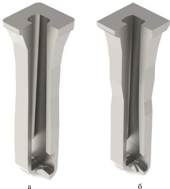
Рис. 1. Схемы конструкций корундографитовых погружных стаканов базовой (а) и усовершенствованной (б) геометрии
