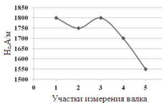
Рис. 4. Распределение по бочке валька: а – коэрцитивной силы; б – твердости
