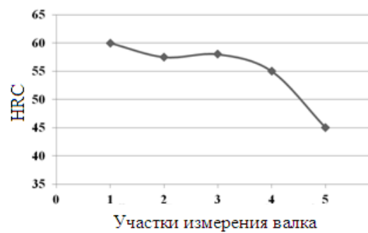
Рис. 4. Распределение по бочке валька: а – коэрцитивной силы; б – твердости
