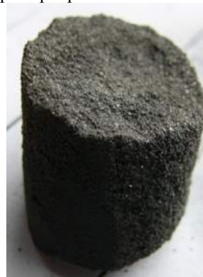
Спек азотированного электролитического марганца методом СВС
