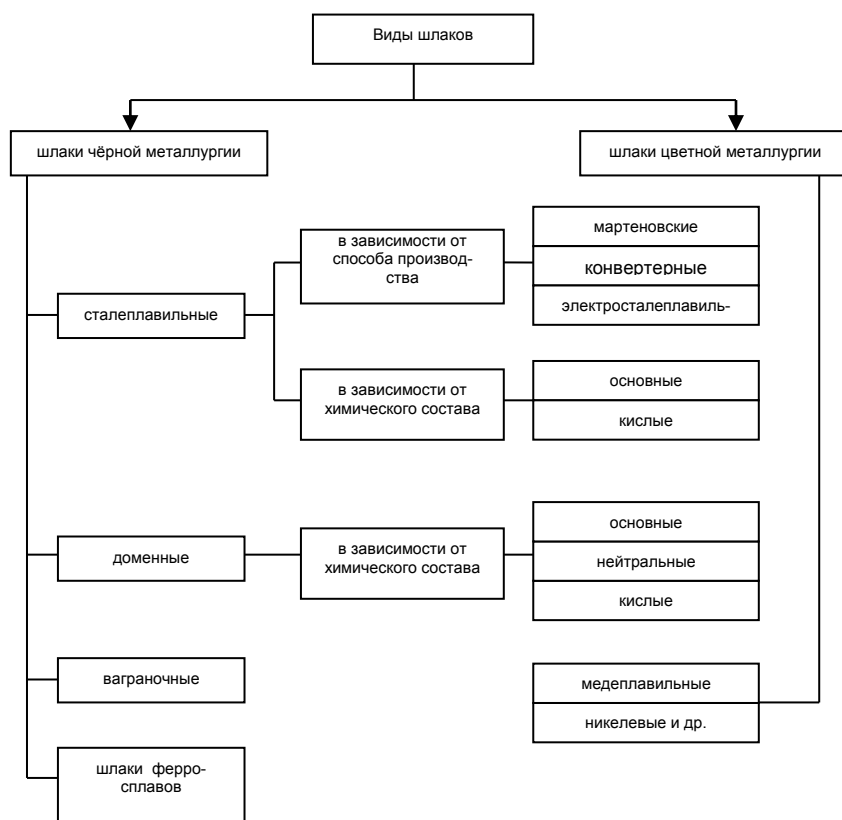
Рис. 1. Классификация шлаков по способу образования
