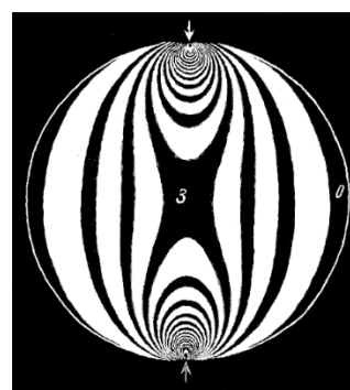
Рис. 1. Картина изохром (линий \sigma_1 - \sigma_2 ) в модели диска, сжатом диаметрально приложенными силами (задача Герца)
