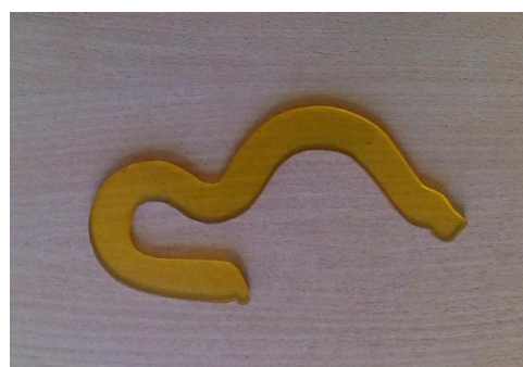
Рис. 8. Оптически активная модель железнодорожного противоугона
