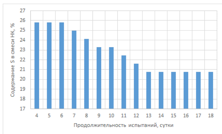
Рис. 3. Изменение содержания серы в смеси НК в период испытаний
