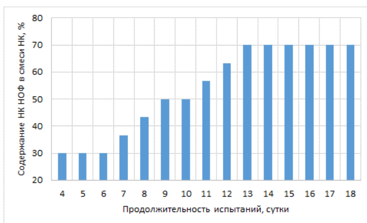
Рис. 2. Изменение состава смеси НК в период испытаний
