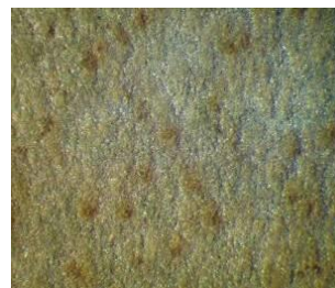
Рис. 1. Очаги питтинговой коррозии на поверхности горячекатаного проката
