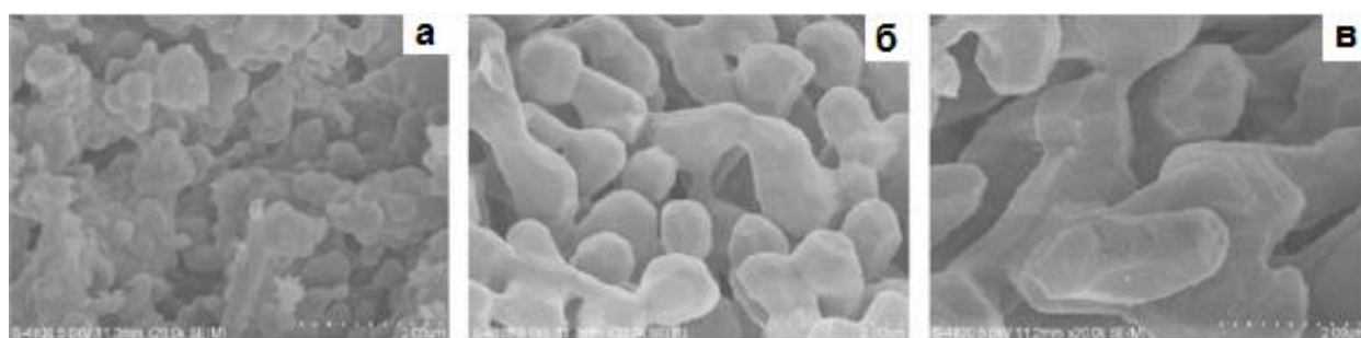
Рис. 2. Характерные микрофотографии частиц извести, обожженной при давлении 0,1 МПа (а), 0,2 МПа (б) и 0,3 МПа (в)
