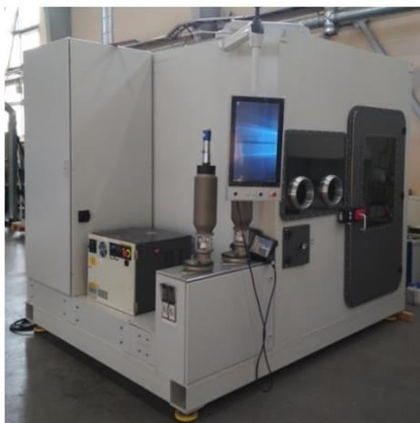
Рис. 3. Установка лазерного выращивания металлических деталей ИЛИСТ
