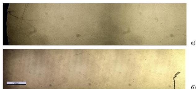
Рис. 5. Фотографии микрошлифов материалов, полученных из порошка ПР-АН55Х45: а – образец №5 без макродефектов; б – образец №4 с трещинами и порами
