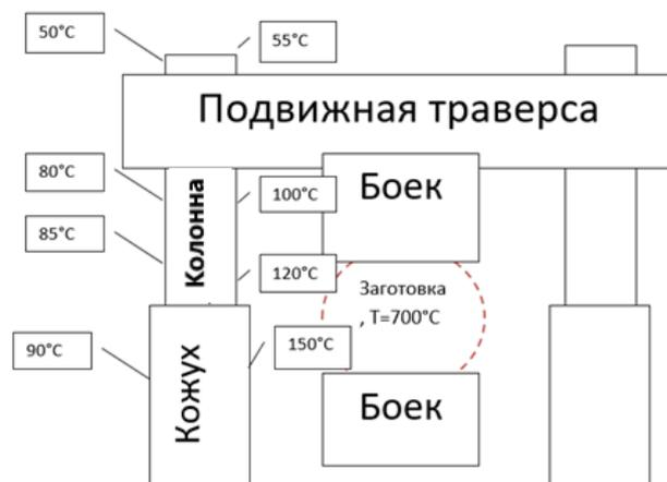
Рис. 4. Схема распределения температуры по высоте колонны прессы «United» США
