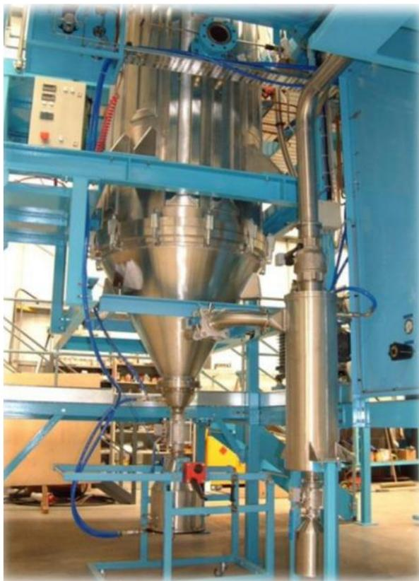
Рис. 1. Установка распыления с вакуумной камерой
