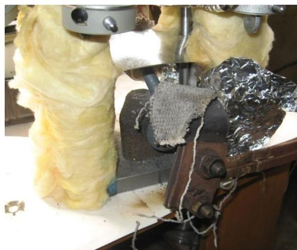
Рис. 6. Процесс, имитирующий расположение нагретой заготовки в рабочем пространстве пресса, и теплоизоляция рамы от нагретых деталей модели пресса
