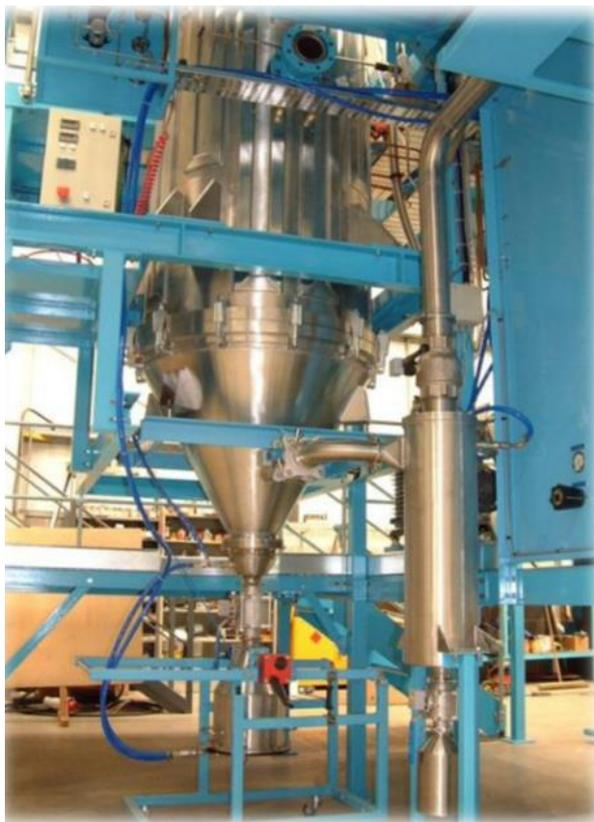
Рис. 1. Установка распыления с вакуумной камерой
