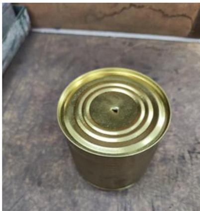
Рис. 2. Металлический контейнер объёмом 420 см<sup>3</sup>, наполненный замасленной окалиной
