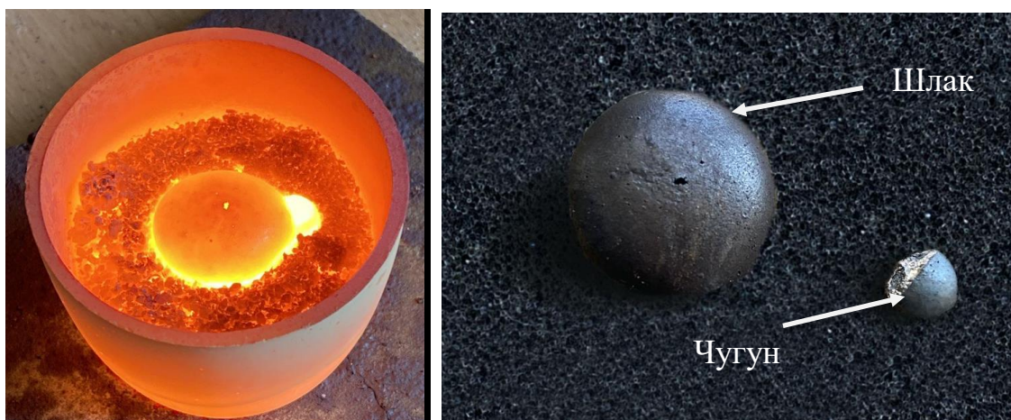
Рис. 5. Продукты плавки шихты на основе руды ООО «Бакальское рудоуправление»
