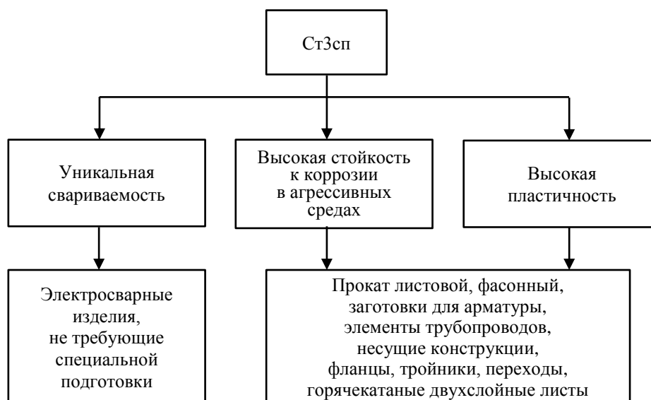
Рис. 3. Функциональные свойства стали СтЗсп для металлоизделий различного назначения
