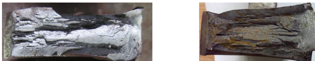
Рис. 3. Вид изломов образцов толщиной 25 мм при испытании падающим грузом
