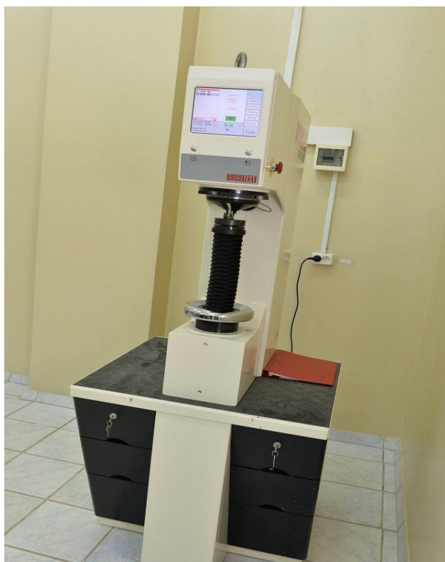
Рис. 11. Твердомер EMCO TEST M4C/R G3 лаборатории ФГБОУ ВО «МГТУ им. Г.И. Носова»
