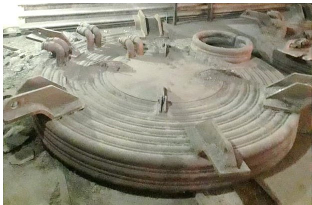
Рис. 5. Полностью водоохлаждаемый свод для работы печи в режиме ГМП
