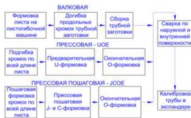
Рис. 1. Технологические операции при производстве прямошовных сварных труб большого диаметра по различным схемам формовки
