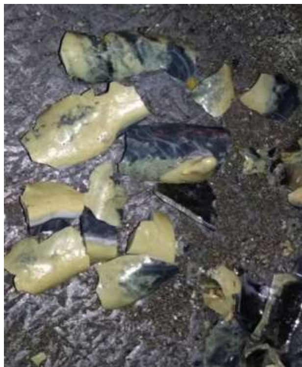
Рис. 2. Шлак с матовой и гладкой поверхностью
