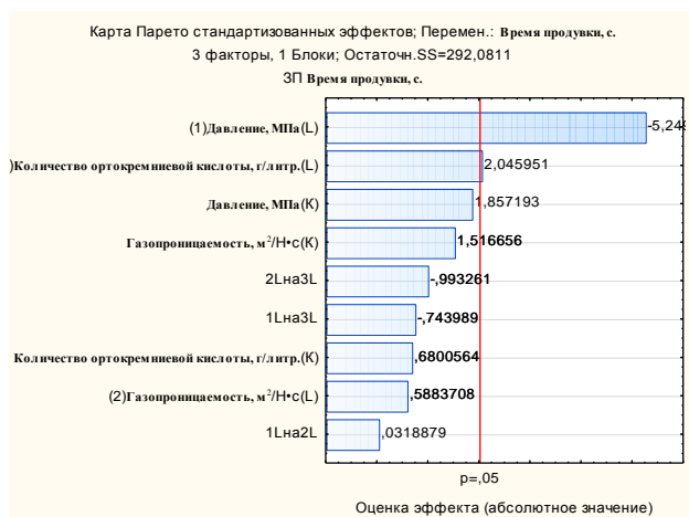
Рис. 2. Влияние факторов на время отверждения жидкостекольной смеси
