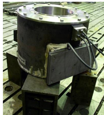
Рис. 3 – Статор ЭМП-3 для литья заготовок сечением диаметрами: от 250 до 360мм
