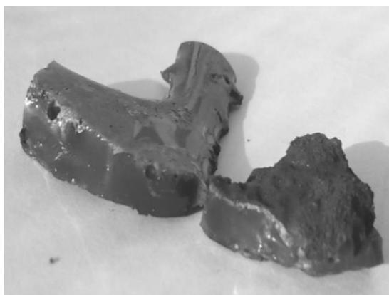
Рис. 2. Образец шлака, отобранный с мениска стали
