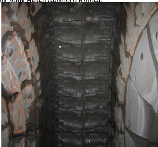
Рис. 9. Вид рабочей поверхности барабанной футеровки после эксплуатации
