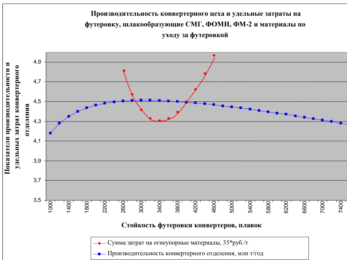
Рис. 4. Производительность конвертерного цеха и удельные затраты на футеровку, шлакообразующие СМГ, ФОМИ, ФМ-2 и материалы по уходу за ней
