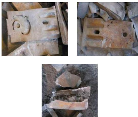
Рис. 1. Скрытые литые дефекты в отливке «Броня торцевая»: усадочная раковина, усадочная пористость
