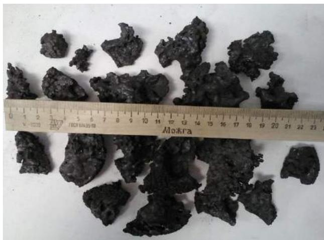
Рис. 4. Гибридный агломерат с избытком твердого топлива
