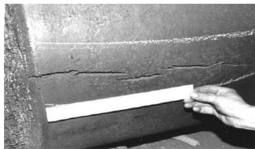
Рис. 3. Продольные горячие трещины на валке
