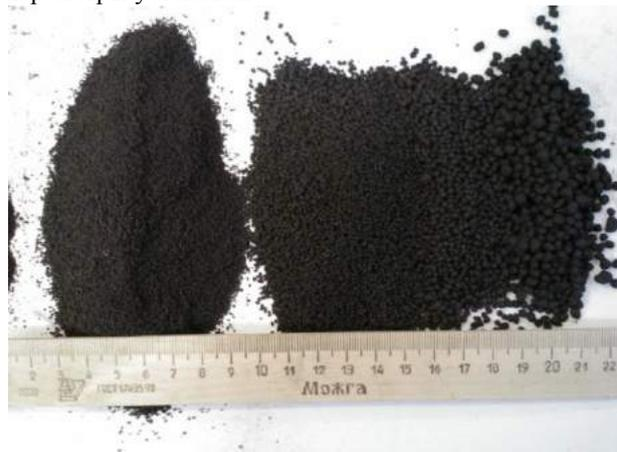
Рис. 2. Полученные в лабораторном грануляторе миниокатыши
