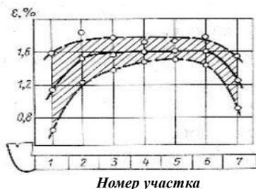
Рис. 1. Изменение усадки по длине образца
