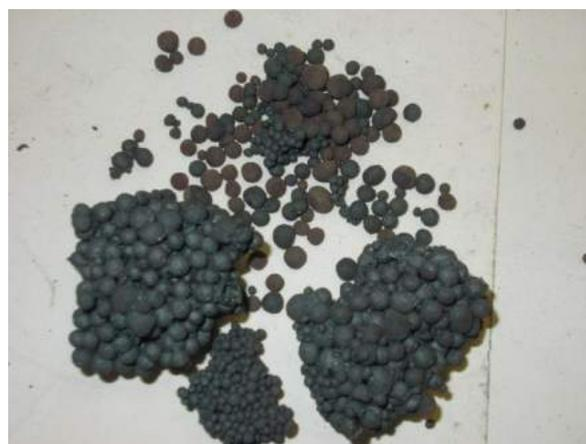
Рис. 3. Гибридный агломерат с оптимальным расходом твердого топлива
