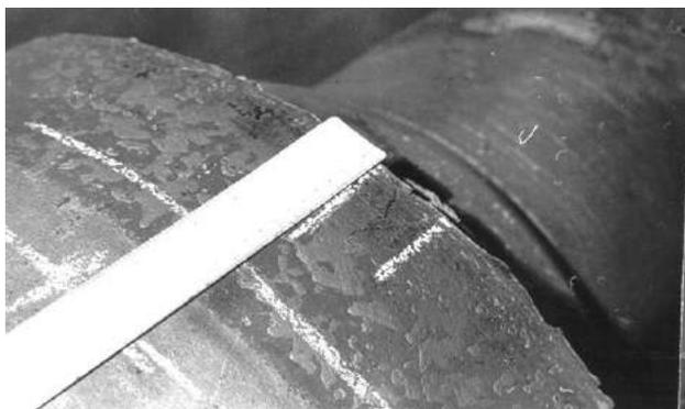
Рис.4. Продольная горячая трещина с края бочки валка
