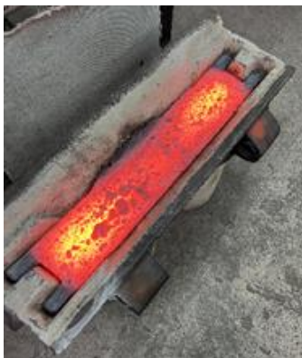
Рис. 6. Заливка раскисленной стали в изложницу
