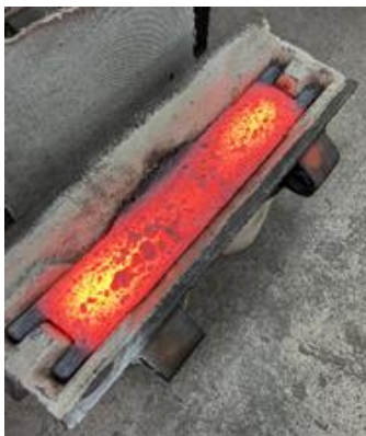
Рис. 6. Заливка раскисленной стали в изложницу
