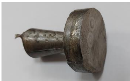
Рис. 5 Проба чугуна ЧХЗ
