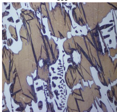
Рис. 2. Микроструктура индефинитного чугуна
