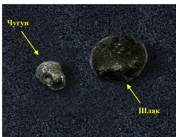
Рис. 3. Продукты плавки шихты из концентрата руды БРУ
