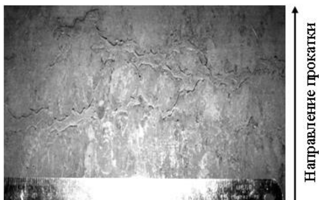
Рис. 2. Внешний вид дефекта «раскатная сетчатая трещина» на поверхности листа
