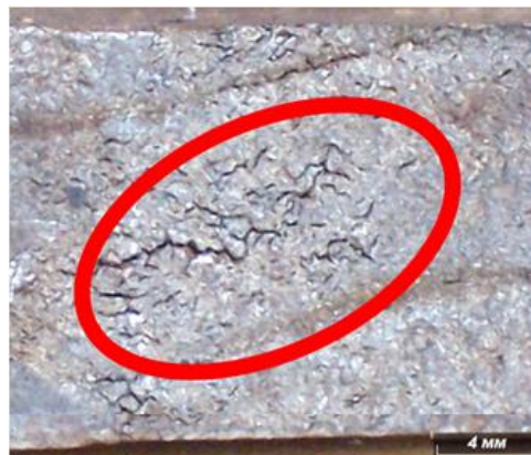
Рис. 1. Макрофотография дефекта «сетчатая трещина»
