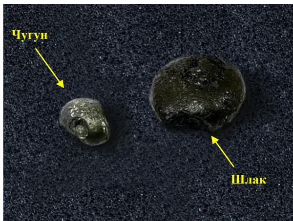
Рис. 3. Продукты плавки шихты из концентрата руды БРУ
