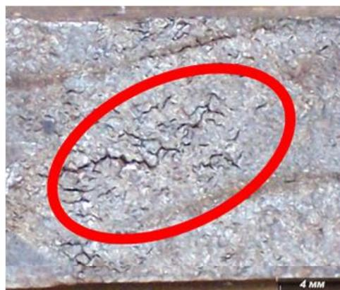
Рис. 1. Макрофотография дефекта «сетчатая трещина»
