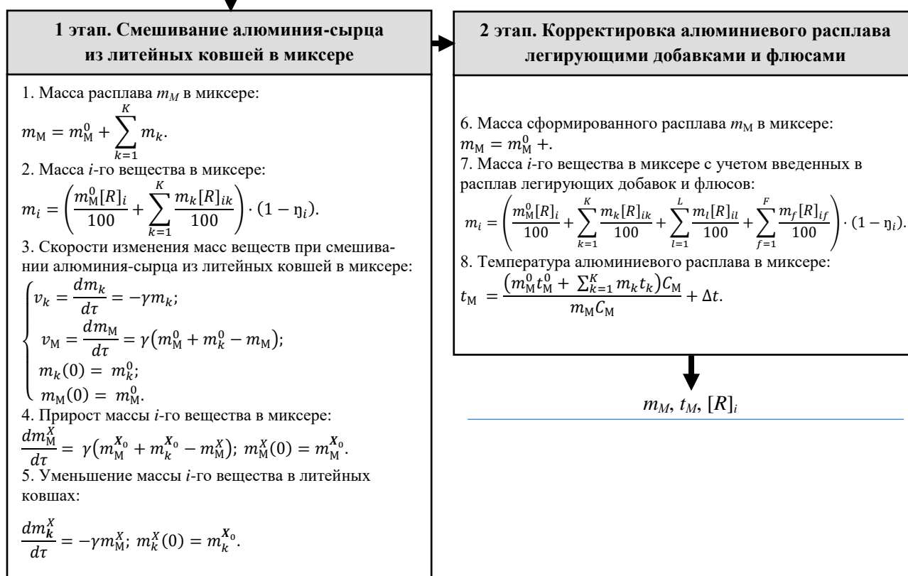
Рис. 2. Блок-схема математической модели процесса формирования расплава в миксере
