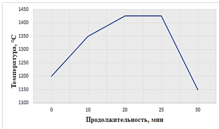
Рис. 4. Температурный режим плавки шихты из сидеритовой руды БРУ
