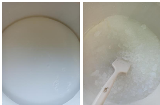
Рис. 1. Осадок основных хлоридов скандия до (слева) и после (справа) промывки горячим раствором \text{NH}_4\text{Cl} 125–150 г/дм 3
