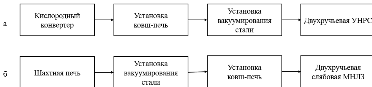
Рис. 1. Технологии получения готового продукта: а – ККЦ; б – ЭСПЦ
