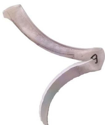
Рис. 11. Разрушенный образец Д16 после симметричной прокатки (обжатие 48 %)
