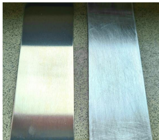
Рис. 8. Образцы алюминиевого сплава 6-й серии до и после подготовки к обработке
