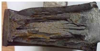
Рис. 3. Вид изломов образцов толщиной 25 мм при испытании падающим грузом
