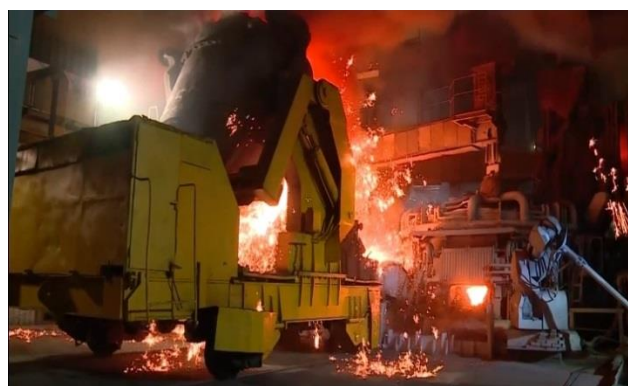
Рис. 1. Заливка жидкого чугуна в ДСП
