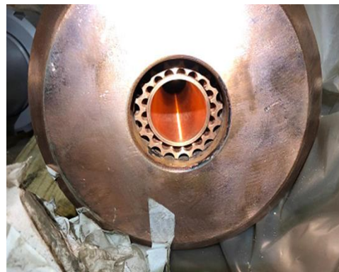
Рис. 4: а – газокислородная фурма-горелка и угольный инжектор; б – наконечник газокислородной фурмы-горелки
