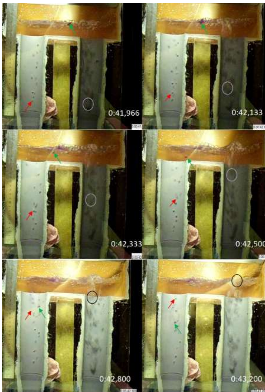
Рис. 3. Кадры видеосъемки изучения гидродинамики циркуляционного вакуумирования:
