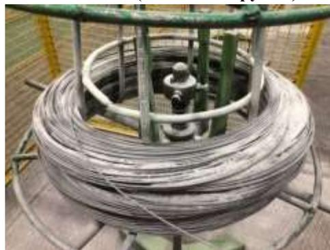
Рис. 3. Поверхность проволоки при использовании сухих смазок СВСУ и СМС-М28
