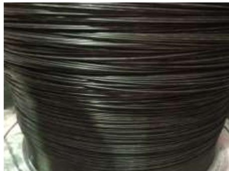
Рис. 4. Поверхность проволоки при использовании сухих смазок Lubrifil VA 1520 и PANLUBE S 2800 V
