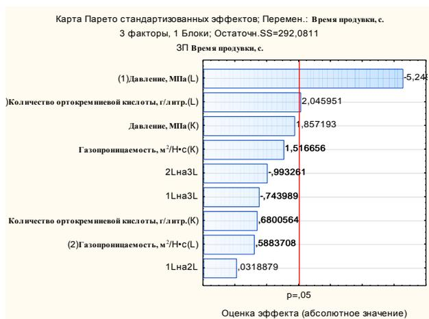
Рис. 2. Влияние факторов на время отверждения жидкостекольной смеси
