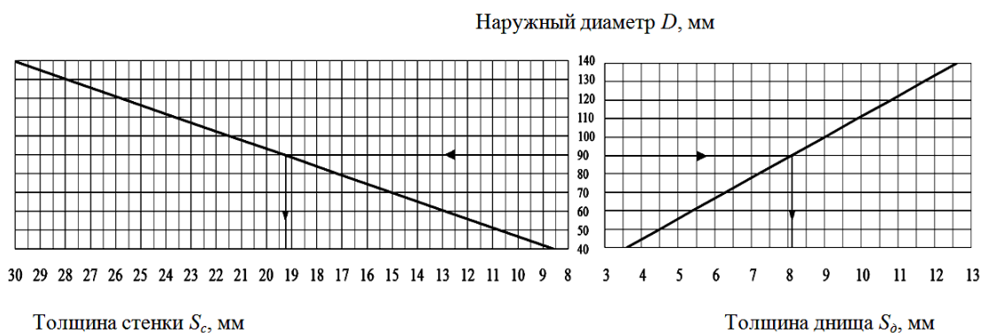
Рис. 5. Номограмма для определения минимально допустимой толщины стенки S_c и днища S_d поршня при заданном его наружном диаметре D
