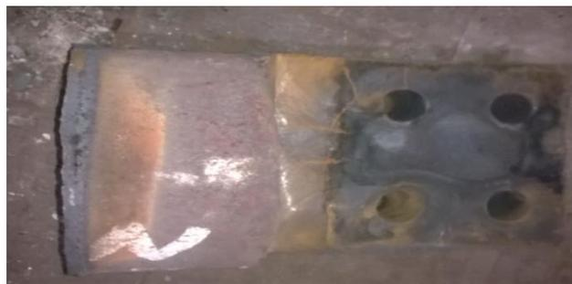
Рис. 3. Огарок сплавляемой части электрода ЭШП ножевой марки стали
