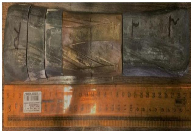
Рис. 1. Вид составных частей осевой поперечной пробы из непрерывнолитого сляба особонизкосернистой стали марки DNV SAWL 485 FD: r, R – верхняя и нижняя стороны заготовки
