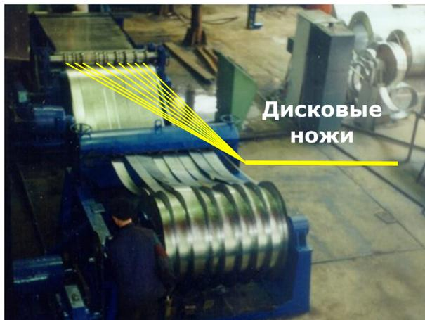
Рис. 1. Агрегат продольной резки в работе
